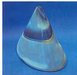
楕円錐型ファントム (Elliptical Cone phantom) H320mm 縦横比 1.5 とし体軸上、スライス断面の面積が円錐ファントムと等価
