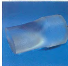
縦横比変化型ファントム (Variable XY phantom) 200mm φ 1.0 から 2.5 まで変化
