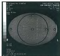
楕円吸収体ファントム+被曝線量測定用ファントム 低コントラスト測定部付きイメージ
