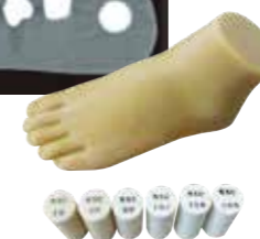
CT 用痛風ファントム 尿酸ナトリウム定量ファントム 関節痛風炎症部位と測定ロッドを CT で同時撮影し、尿酸ナトリウムの定量評価
