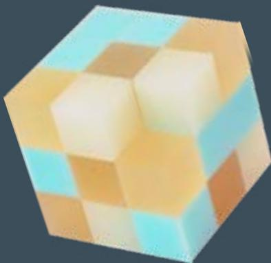
XCUBEFANは、「ロボットコンテスト」のような専門知識や技術を駆使しながら学ぶ教育コンテンツが診療放射線技師の教育でも欲しくて開発した物です。このため、放射線の知識や技術を使いながら試行錯誤する仕組みと、チームによる対戦型にしてチーム力を養うように工夫しています。利用する素材は、極めてシンプルな構造になっています。X線の吸収率が異なる3種類の立方体ファントムで、1辺の長さが2cmです。そして、立方体ファントムを縦横高さに各3個並べて入れることができるボックスです。ほぼ隙間なく入れることができ、不透明の黒色でブラックボックスと呼んでいます。ブラックボックスの27か所の立方体ファントムが、3種類のうちのどれなのかを、X線撮影をして解析するのが基本的な使い方です。
