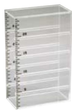
各測定部が5、10、15、20mmの高さに設置できる構造になっています。
