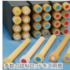
[TR-J型] JIS Z4915 規格に準拠した 真・等価X線水ファントムと断面形状が同じ
