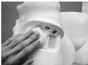
髌骨下の穴にそれぞれ1コネクタ-2チューブの順に挿入し、部位センサーと土台のマジックテープ部を合わせ押し付ける。
