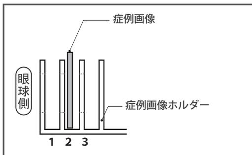
左の図に示すように1のスリットに症例画像を挿入すると遠視、2に挿入すると正常、3に挿入すると近視状態になりますので、直像眼底鏡レンズ度数変更を理解する練習になります。
