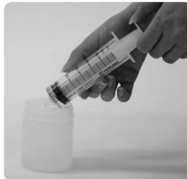
4. 本体から出ているチューブ（2本）の先端にある三方活栓にシリンジを差し込み、これから実習されるポイント（気管または咽頭部）にコックを切り替えて、適量の模擬痰を注入してください。
