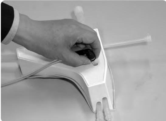
Desconecte la unidad de pulsación de la almohadilla. El tubo se puede desconectar por empujar el anillo de bloqueo hacia el conector.
