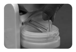
1. Descarque la sangre simulada desde el sistema. Levante el tubo de succión para que el extremo del tubo quede arriba de la superficie del líquido y deje la bomba de circulación funcionar hasta que el líquido en los tubos salga al frasco.
