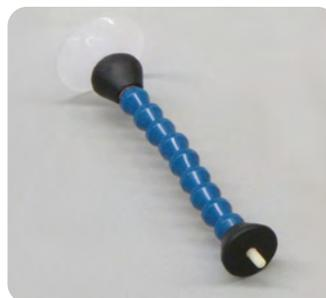
腸管固定具は片側が吸盤、もう一方は模擬腸管取付け用のネジになっています。
