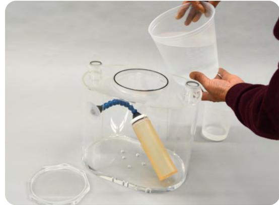
4. 注水後容器の蓋を閉め、容器の上面にある樹脂栓をはずして、容器を少し傾けながら、容器内に空気が残らないようを再度注水します。
