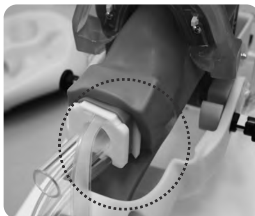
セットが不具合の状態 (※分かりやすくするため気管支部を外して撮影)
