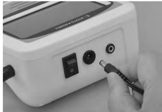
● Conecte el adaptador de CA a la corriente eléctrica y presione el switch de encendido en la parte posterior del dispositivo de control.
