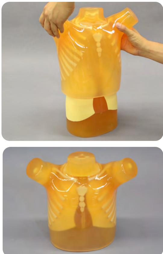
⑤ 毛細血管付き心臓、肺野部挿入のどちらの場合も、横隔膜下部より線量計の挿入が可能です。
