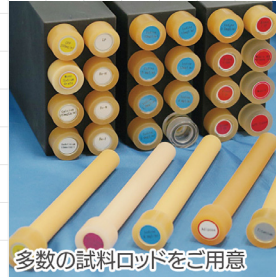
[TR-J型] JIS Z4915 規格に準拠した 胸・腹部X線水ファントムと断面形状が同じ
