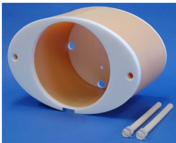
B 被曝線量測定用ファントム 楕円胴体
