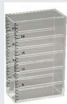
Se pueden colocar las unidades de prueba en la caja de soporte de aluminio en las alturas de 10, 15 o 20 mm (0.4, 0.6 o 0.79 plgds.).
